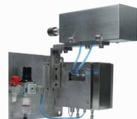
超过100毫米的检测距离排除了检测头和容器之间的碰撞。容器尺寸的变化，容器的不对中和传送带的振动都不影响检测效果。
